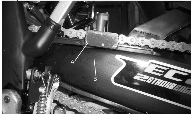
(A). Patín guía cadena. (B). Brazo basculante.
