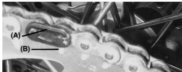
(A). Clip. (B). Dirección de la rotación de la cadena.
