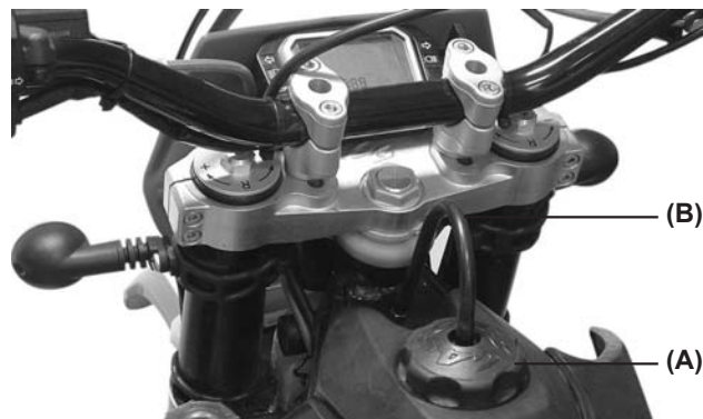
(A). Tapón depósito. (B). Tubo desvaporizador.
