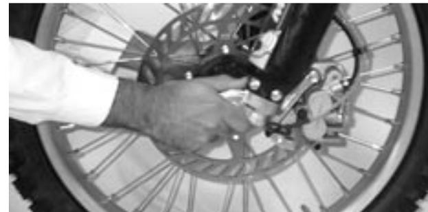
Para comprobar el ajuste de la dirección, levantar la moto del suelo, utilizando un soporte debajo del chasis. Mover el manillar suavemente a cada lado, si al dejar el manillar continúa moviéndose por sí solo, quiere decir que la dirección no está demasiado apretada. Agáchese delante de la moto, agarre la parte más baja de la horquilla delantera (en el eje), empuje y estire la horquilla (tal i como se muestra en la imagen anterior); si hay juego la dirección, está demasiado suelta.
