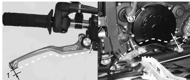
Compruebe si la altura del pedal de freno es correcta. Si la altura del pedal es incorrecta, solicite a un taller especializado que la ajuste.
