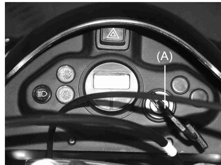
2.- Girar la llave en sentido antihorario (posición "OFF"), el motor se parará automáticamente.
