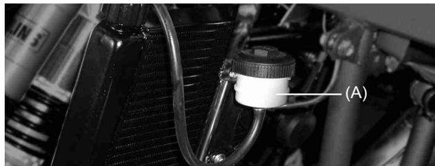
Compruebe el nivel de refrigerante en el depósito (A) con el motor frío (el nivel de refrigerante varía con la temperatura del motor). El nivel será satisfactorio si se encuentra entre las dos marcas. Si el nivel está por debajo añada anticongelante. Cambie el refrigerante cada dos años.
