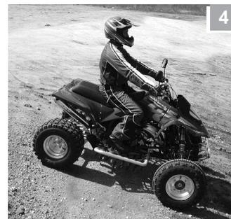
Elija una velocidad corta que permita que la compresión del motor actúe como freno principal. Un frenado incorrecto puede dar lugar a la pérdida de tracción. Vea el ejemplo en la imagen.
