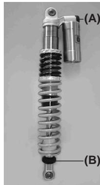
Para ajustar la extensión girar el mando **(B)** de la parte inferior del amortiguador con la mano.
