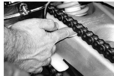
El espacio entre la cadena y el brazo del basculante a la altura del patín de la cadena debe ser de un dedo, si fuera superior o inferior ajustar a la medida correcta. Seguir el procedimiento que explicaremos a continuación:
