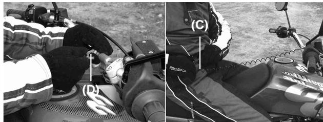
La extremidad (C) irá sujeta al vehículo y la extremidad (D) irá fuertemente sujeta al piloto.
