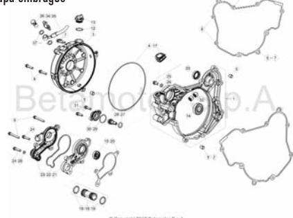
TAV.01B Coperchio frizione - Clutch cover - Couvercle d'embrague - Kupplungsdeckel - Tapa embrague
