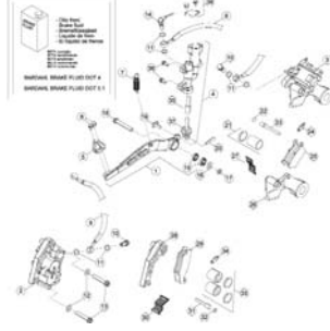
TAV.22 Impianto freni idraulici - Hydraulic brakes system - Installation des freins hydrauliques - Hidraulischebremse anlage - Instalación freno hidráulico
