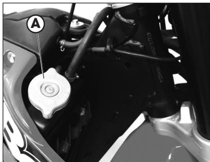
Una vez concluida la operación, volver a montar el tapón de carga.
