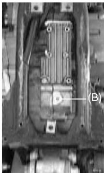
2. Vaciar el aceite del motor del cárter quitando el tapón (B), manteniendo siempre la moto horizontalmente.
