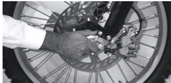
Para comprobar el ajuste de la dirección, levantar la moto del suelo, utilizando un soporte debajo del chasis. Mover el manillar suavemente a cada lado, si al dejar el manillar continúa moviéndose por sí solo, quiere decir que la dirección no está demasiado apretada. Agáchese delante de la moto, agarre la parte más baja de la horquilla delantera (en el eje), empuje y estire la horquilla (tal y como se muestra en la imagen anterior); si hay juego la dirección, está demasiado suelta.
