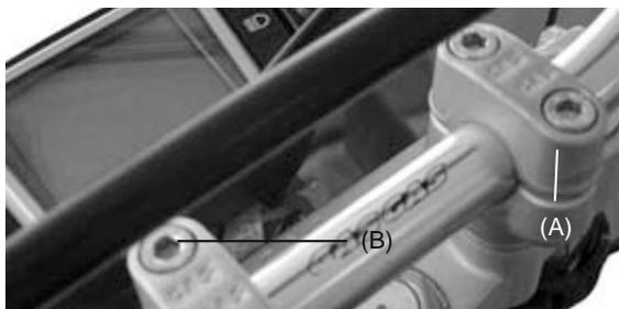
Aflojar los tornillos (B) de la abrazadera del manillar (A) y colocar el manillar en la posición deseada.
