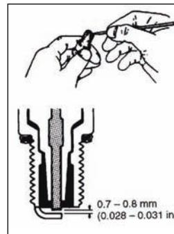
9. Sacar la bujía y limpiar la carbonilla depositada en la bujía con un cepillo metálico. Reajustar la separación de los electrodos entre 0.7 - 0.8 mm. (0.028 - 0.031 in).
