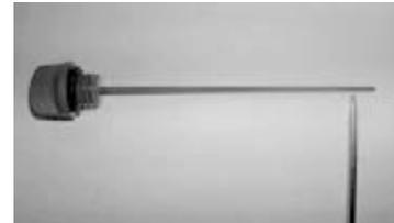
12. Si es necesario, añadir más aceite nuevo a través del orificio de la pipa de alineación hasta que el aceite este entre las marcas de la varilla.
