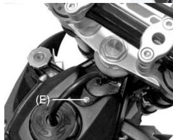
5. Sacar el tornillo de sujeción del depósito (E).
