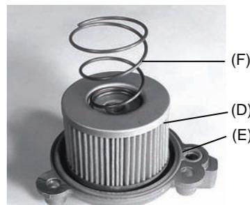
4. Sacar la tapa del filtro, retirar el elemento filtrante (D) y la junta (E). Reemplazar siempre ambos elementos al mismo tiempo.
